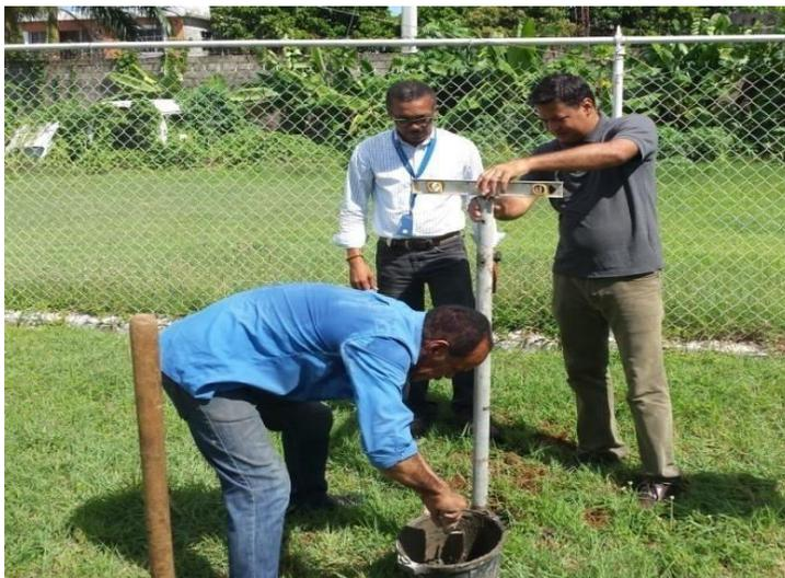
Imagen Instalación de Pluviómetro Colector.
